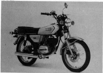
Moteur: 2 temps, monocylindre, alésage et course 56 X 50 mm, cylindrée 123 cm3, compression 6,9 à 1, puissance 14 ch à 7 500 tr/mn, couple 1,3 m/kg à 8 000 tr/mn, carburateur Mikuni 0 24 mm, allumage par volant magnétique, lubrification autolube, mise en route par kick route par kick.
