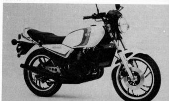
Moteur: 2 temps, 2 cylindres, refroidissement liquide, alésage et course 64 × 54 mm, cylindrée 347 cm3, compression 6,2 à 1, puissance 47 ch à 8 500 tr/mn, couple 4,02 m/kg à 8 000 tr/mn, carburateurs 2 Mikuni Ø 26 mm, allumage électronique CDI, lubrification système autolube de graissage séparé, mise en route par kick
