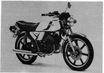
Moteur: 2 temps, 2 cylindres, admission par clapets, alésage et course 43 × 43 mm, cylindrée 124 cm3, compression 6,8 à 1, puissance 17 ch à 9 500 tr/mn, couple 1,3 m/kg à 8 500 tr/mn, carburateurs Teka Ø 18 mm, allumage batterie-bobine, lubrification séparée, mise en route par kick
