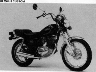
Moteur: 4 temps, monocylindre, alésage et course 73,5 × 56,5 mm, cylindrée 239 cm3, compression 8,9 à 1, puissance 20 ch à 8 000 tr/mn, couple 1,83 m/kg à 7 000 tr/mn, carburateurs 1 Mikuni Ø 28 mm, allumage électronique CDI, lubrification sous pression carter humide, mise en route par démarreur électri-
