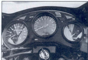
Yamaha RD350LC:n mittaristo on muuten selkeä ja helpopolkuinen, mutta mittareiden kiltäät lasit häiritsevät niiden seuraamista.
