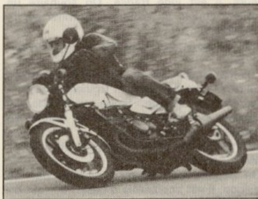
Luc : béquille centrale limite la garde au sol.
