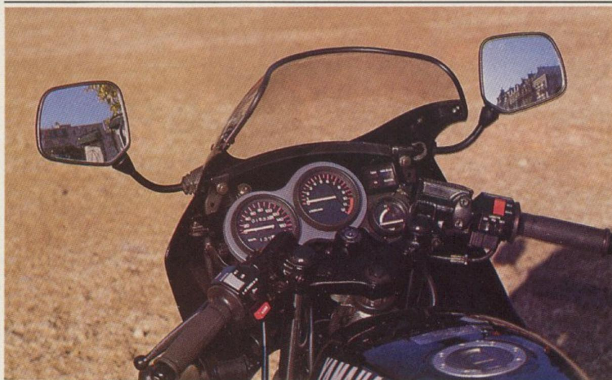
Le tableau de bord est classique et néanmoins lisible avec le compte-tours centré. La bulle de carénage, malgré sa dimension réduite, protège convenablement le pilote.
