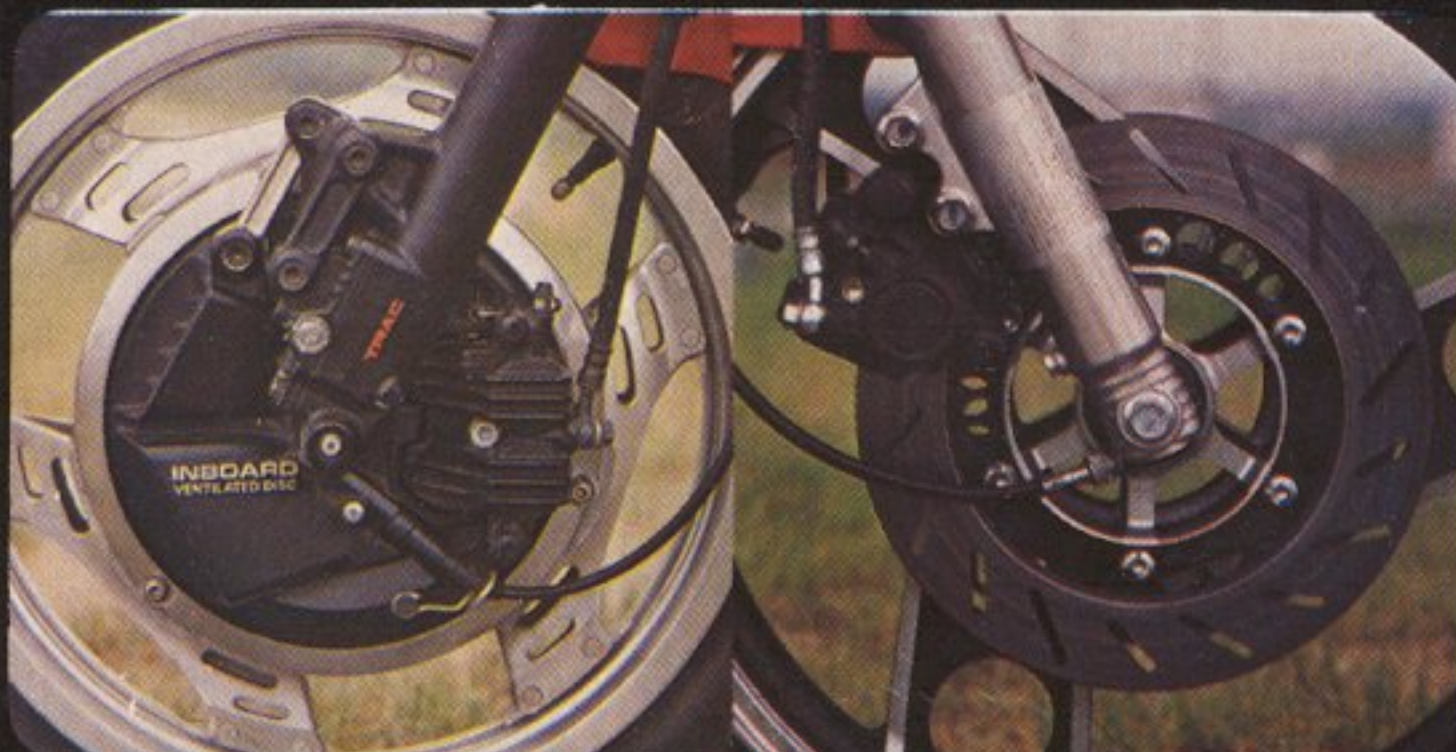
Ci-dessus à gauche, le frein avant inboard de la Honda, et à droite, le double disque avant de la Yam. Ce dernier est plus efficace que le simple disque en fonte.
