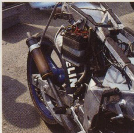
Le système électrique est du RDLC simplifié. Notez le support de batterie en kevlar et la durit qui fait office de réservoir de lockheed.
