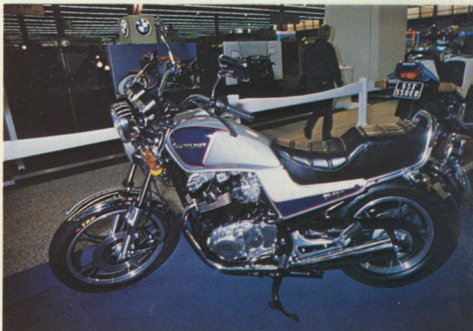
GR 650 Conception moderne sur architecture ancienne. Un V Twin à chaîne mais avec un Full-Floater.
